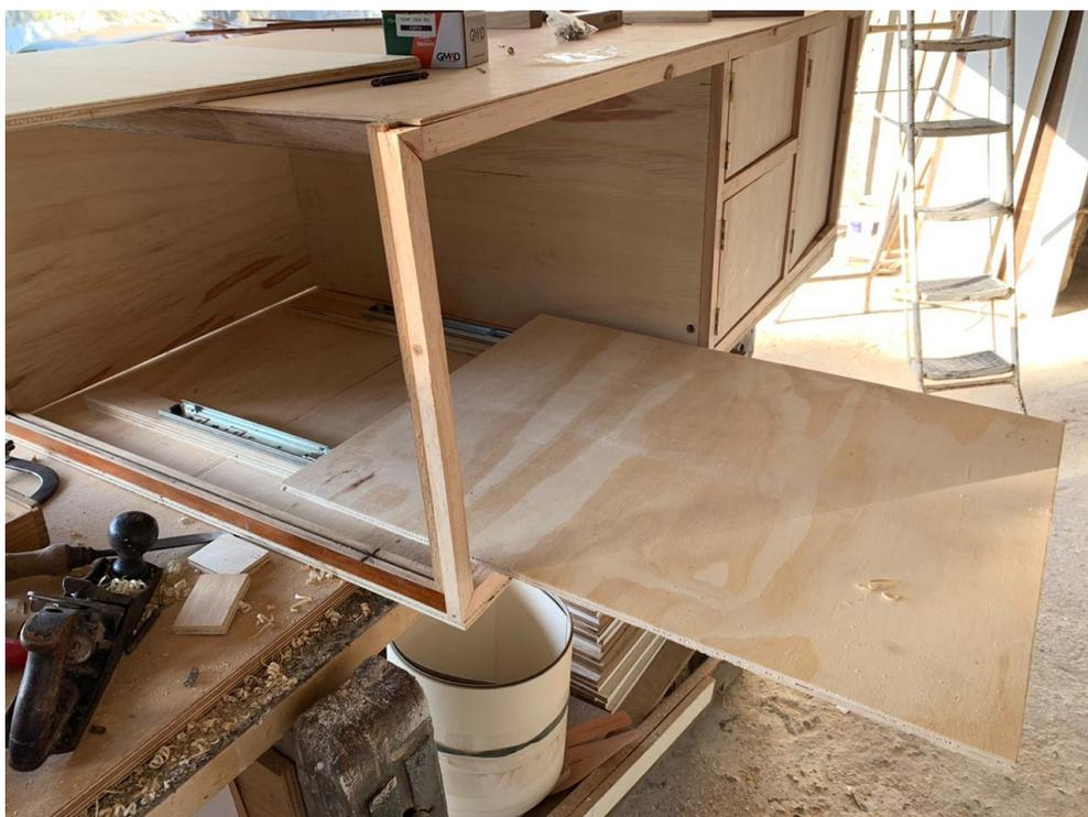
**Figura 60- Bandeja retrátil**
